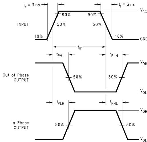
**FIGURE 3. AC Waveforms**
